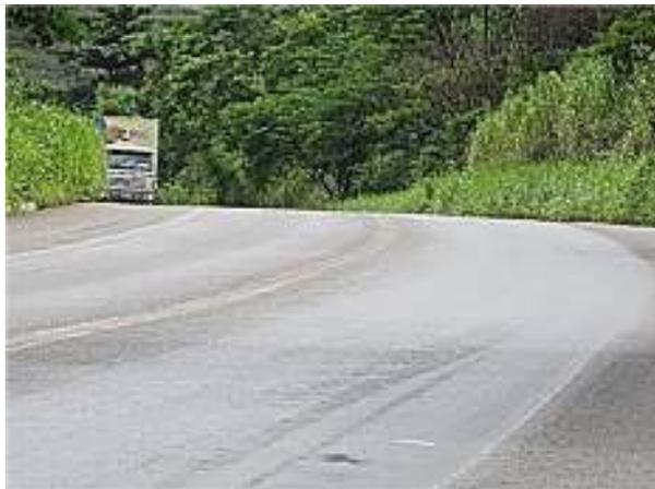
Falha em Pintura Horizontal – Perda de Visibilidade
